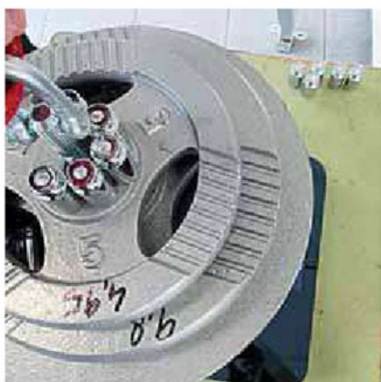
Abychom poznali, jak jsou přístroje citlivé, přidávali jsme postupně 100gramová závaží.
